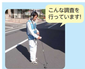
図 5-5 漏水調査の様子
