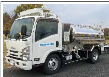
切り替え作業時に応急給水所に配備される給水車
